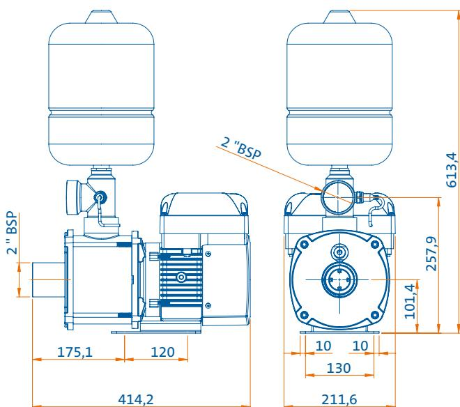
O Pressurizador Jet Comfort® Inverter 55 é um produto constituído basicamente por uma bomba multiestágio em aço inoxidável, motor de imã permanente, vaso de expansão, sensor de pressão e um controlador inteligente com inversor integrado que será responsável pela melhor eficiência no funcionamento do equipamento, entregando maior conforto na utilização dos pontos de consumo de água, baixo ruído durante o funcionamento, além de proporcionar até 60% de economia no consumo de energia elétrica.
