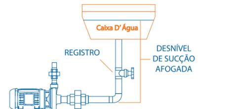
Quando se tratar de bomba afogada, a operação de escorvamento se processa automaticamente abrindo-se o registro
